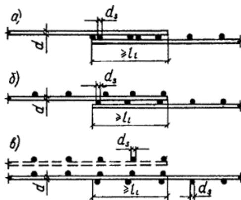
Черт. 107. Стыки сварных сеток внахлестку в направления рабочей арматуры, выполненной из гладких стержней
